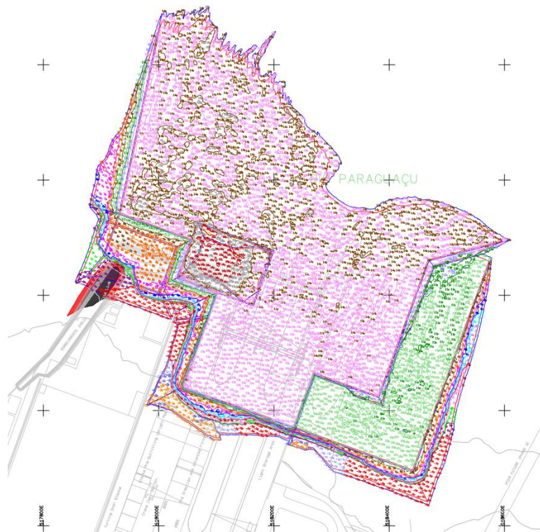
FIGURA 6 - LEVANTAMENTO HIDROGRÁFICO FINAL - PÓS DRAGAGEM 2012. /09/
